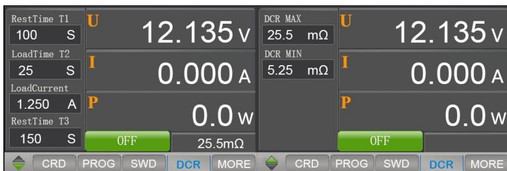
Figure 4-39 DCR test parameter setting interface
